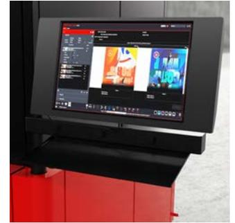
Die **grafische Benutzeroberfläche (GUI)** des Jeti Tauro H2500 LED steuert die ABF an und führt den Operator Schritt für Schritt durch den Prozess zum korrekten Laden der Platten.
