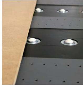
Die ABF-**Vakuumriemen** des Jeti Tauro sind stets perfekt ausgerichtet und führen die Medien reibungslos in die Druckmaschine. Mehrere Auslasswalzen am hinteren Ende des Tisches unterstützen die Zuführung. Während eine Platte bedruckt wird, werden die nächsten Platten zum Laden vorbereitet.
