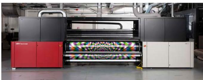
Der Jeti Tauro H2500 ist standardmäßig mit einer Lightrolle ausgestattet, die mit einer Masterrollen-Einheit kombiniert werden kann. Sie wird für gelegentliche Rollenaufträge mit Einzelrollen verwendet.
