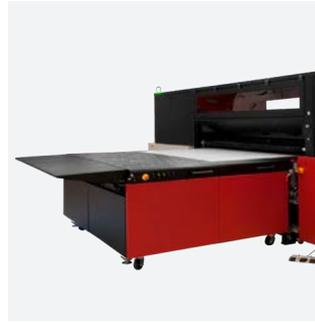
Die automatische Plattenzuführung (ABF) verarbeitet **bis zu 4 Platten** mit einer maximalen Länge von 1,85 m nebeneinander. Für längere Platten (bis zu 4 m) ist ein Bypass möglich.
